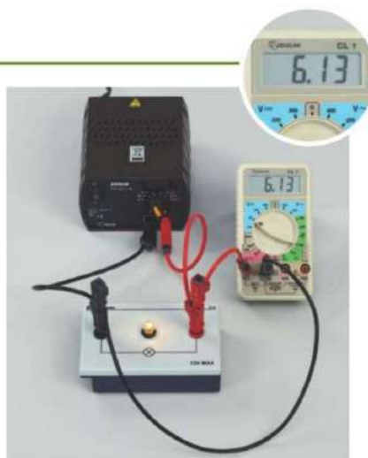
Fig. 2 : La tension du générateur est environ égale à la tension nominale de la lampe.
