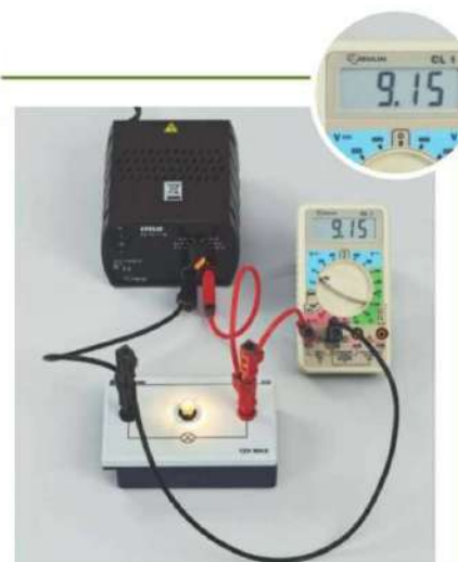
Fig. 3 : La tension du générateur est supérieure à la tension nominale de la lampe.
